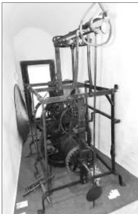
Kovaný barokní věžní hodinový stroj s vřetenovým krokem
